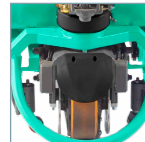
#7 Doppelte Scheibenbremsen (1.5to-Modell) verbessern die Bremsleistung.
