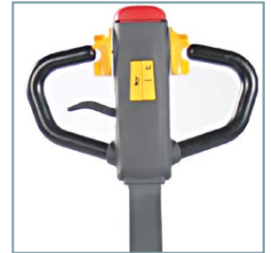
#3 Der ergonomische Deichselkopf mit stufenloser Geschwindigkeitsregelung bietet hohe Produktivität.
