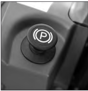
Ideal – betätigen der automatischen Handbremse per Knopf
